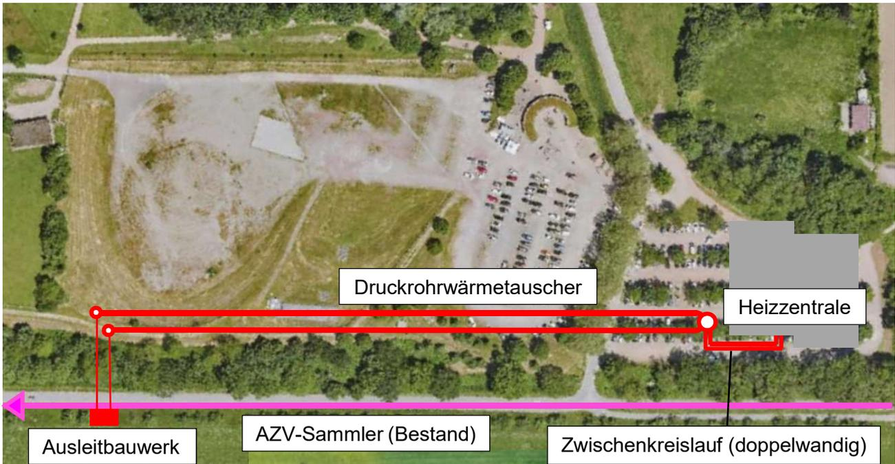
Abb. 16 Anordnung des Druckrohr-Wärmetauschers (Kartenausschnitt nicht genordet, Quelle Luftbild: FreiGIS, Stadt Freiburg)
