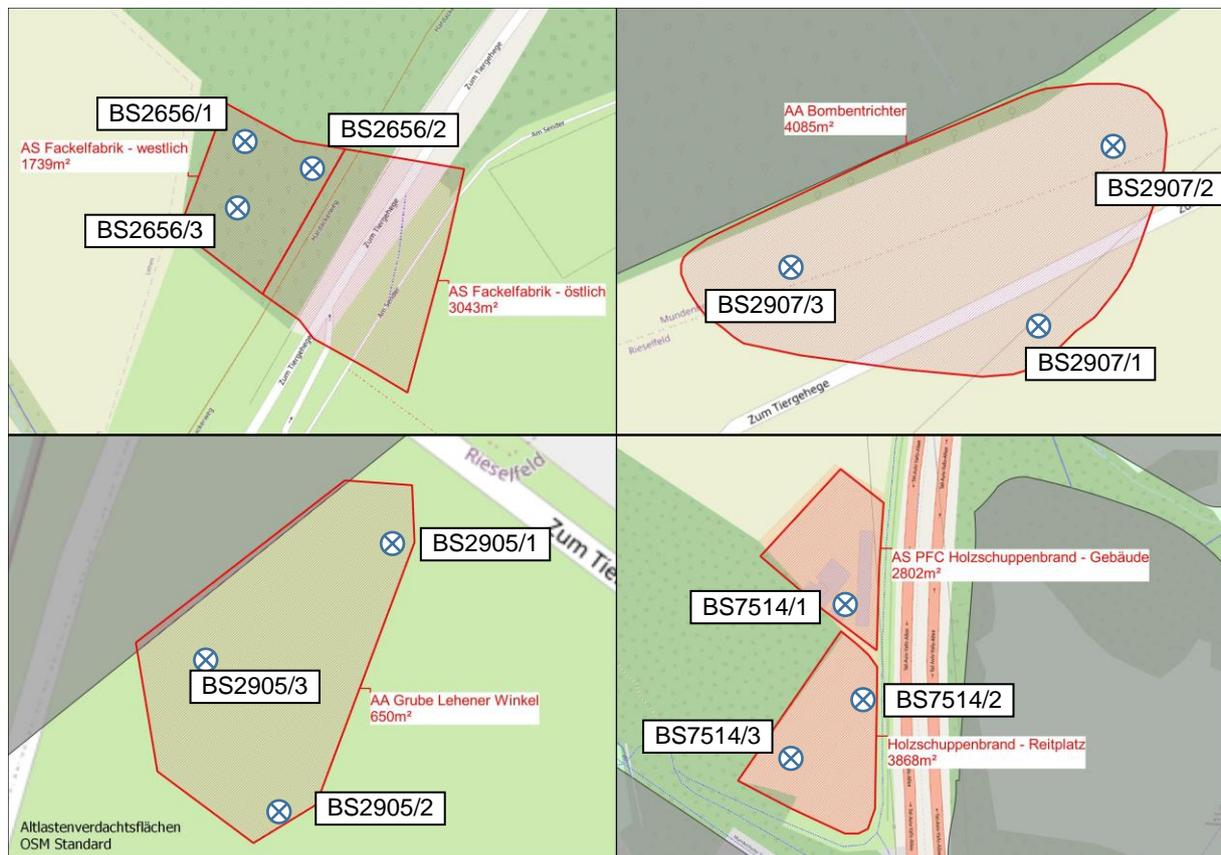
Abbildung 22: Flächengrößen der Altlastverdachtsflächen als Grundlage für die Massenberechnung (Bohrungsnummern nach Geosens GmbH 2021)
