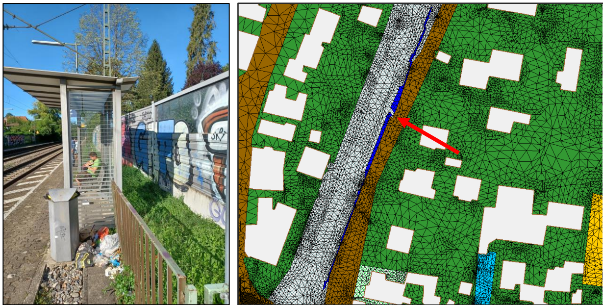
Abbildung 6: Veranschaulichung der Modellanpassung zur Berücksichtigung der Lärmschutzwand östlich der Bahnstrecke
