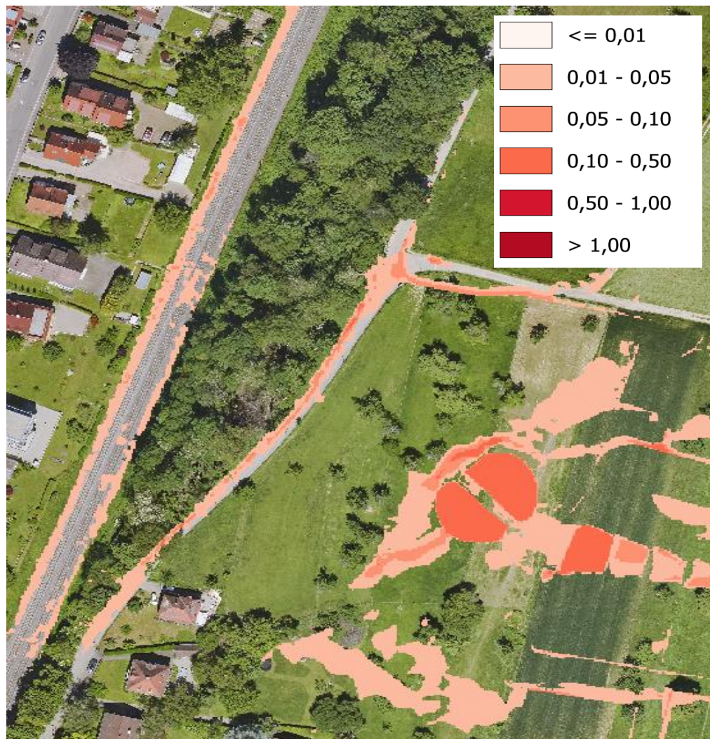
Abbildung 38: Differenzen der Fließtiefe, Variante V2, Bahnlinie - außergewöhnlich
